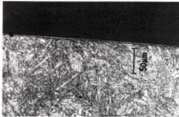
Figure 24 : Microstructure de la surface d'un 32 CrMoV 13 (Hv270) usiné à l'outil céramique à 300 m/min et 0,2 mm/tr [3].
