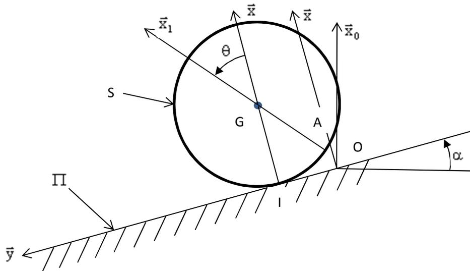
Soit  $R(O, \bar{x}, \bar{y}, \bar{z})$  un repère galiléen lié au plan  $\Pi$ , l'axe  $(O, \bar{y})$  étant dirigé suivant la ligne de plus grande pente. Le cylindre de révolution  $(S)$ , homogène, de masse  $m$ , de rayon  $R$ , et de centre d'inertie  $G$  a pour axe de révolution  $(G, \bar{z})$ .
