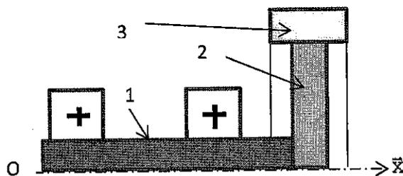
Pour cela on monte au bout de l'arbre 1, de masse  $m_1$  de longueur  $\ell_1$  de rayon  $r_1$ , un volant d'inertie composé d'un arbre 2 de masse  $m_2$ , de longueur  $\ell_2$ , de rayon  $r_2$  et d'un tube 3, de rayon intérieur  $r_2$ , de rayon extérieur R et de longueur  $\ell_3$ .
